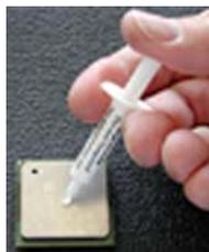
Appliquez une goutte de graisse thermique Céramique sur le processeur, et installez le water-block sur le processeur directement.
