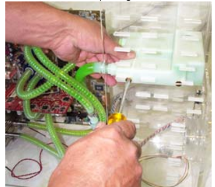
Figure 6: Une fois le réservoir rempli, utiliser les vis fournies pour le fixer dans l'emplacement de 5/16". Installation terminée !
