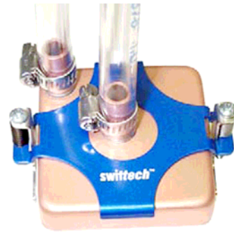
Tuyaux attachés avec les serre-tubes fournis (Plaque de fixation AMD)
