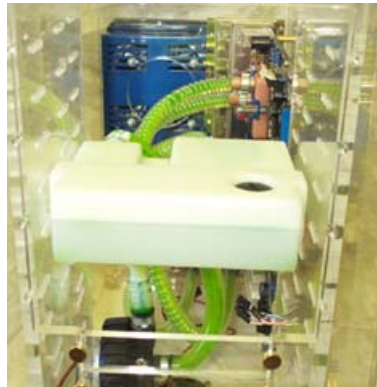
Figure 3: Le niveau de liquide minimum correspond au joint de fabrication du réservoir.
