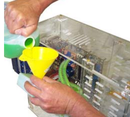
Figure 4: Il est aussi possible de remplir le réservoir à l'extérieur du boîtier, ce qui permettra la mise à niveau maximum (fig. 5). Ne pas oublier de refermer le bouchon de remplissage une fois terminé!
