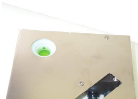
3. Reposer le dispositif MCRES-1000P sur une serviette sur le panneau supérieur du PC. Utiliser un entonnoir et remplissez le réservoir LENTEMENT pour éviter qu'il ne déborde. Remplir jusqu'au niveau indiqué à droite ----->
