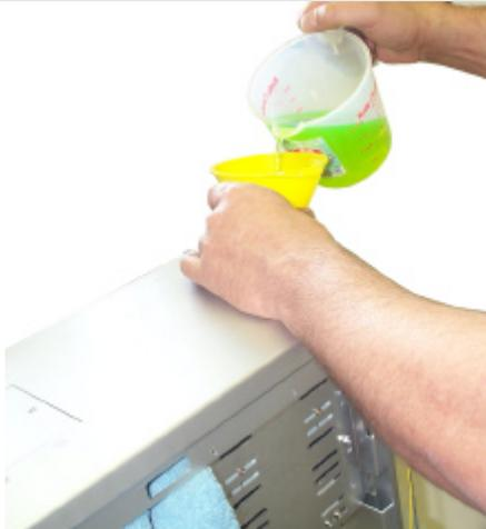
3. Remplissez le réservoir à l'aide d'un entonnoir ménager jusqu'au niveau approprié (paragraphe 3, chapitre I). Remplissez lentement afin d'éviter les débordements.
