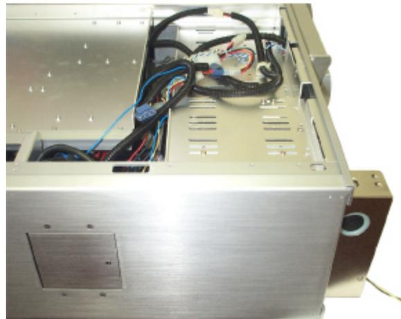
6. Remettez le PC en position normale, et complétez le niveau. **Le system est prêt à l'emploi.** Complétez l'installation en fixant le dispositif MCRES1000 dans la baie 5 ¼ à l'aide des vis M3 fournies à cet effet ([paragraphe 8](#), chapitre I)
