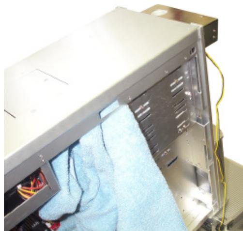
2. Reposez l'avant du PC sur un support quelconque afin qu'il soit à un angle d'environ 20° par rapport à l'horizontale. Obtenez la partie arrière du dispositif MCRES10000 à l'aide d'une serviette ou linge de maison afin d'éviter que le liquide ne se repende sur les composants en cas de débordement accidentel.
