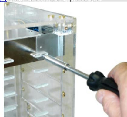
8. Installer le dispositif dans la baie CD Rom désirée et le fixer à l'aide des vis M3 fournies. Le MCRES-1000P se monte en retrait de la façade aux fins de compatibilité avec diverses plaques de façade ou contrôleurs de ventilateur. Brancher le connecteur Molex 4 broches de la pompe à l'alimentation et le connecteur 3 broches du capteur RPM au connecteur ventilateur CPU de la carte mère. **L'INSTALLATION EST MAINTENANT TERMINEE !**
