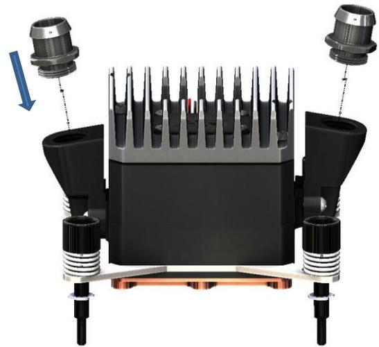
Installez les raccords fournis – Vissez les raccords jusqu'à ce qu'ils entrent en contact avec la surface du port, puis donnez un quart de tour supplémentaire en utilisant un outil (une clef de 16mm) pour les bloquer en place.
