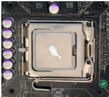
Nettoyez le CPU avec un dégraissant (de préférence spécialement conçu pour les composants électroniques), puis appliquez la pâte thermique Tim-Mate fournie au centre du CPU.
