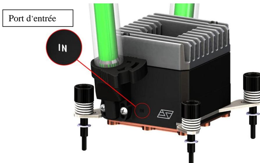
Connectez les tuyaux aux raccords et sécurisez-les avec les colliers fournis. Le port d'entrée du bloc est spécifique : il est marqué par l'inscription "IN" sur le côté du bloc.
